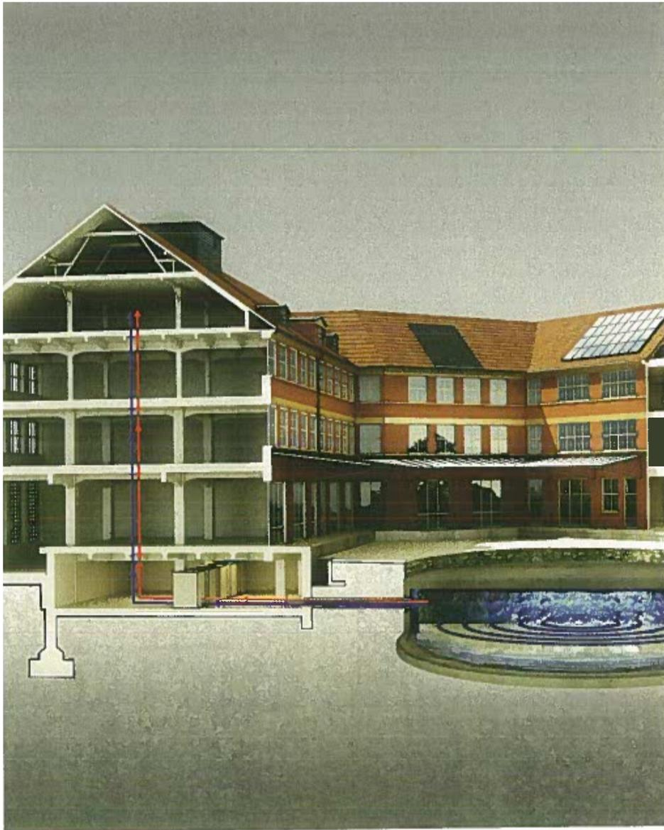
*Der 400 Kubikmeter große Eisspeicher mit gasbetriebener Absorber-Wärmepumpe versorgt das Archiv bei 30 Prozent Kosteneinsparung mit Wärme und Kälte.*
